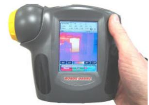
Le verifiche e le analisi termografiche vengono effettuate mediante una termo camera ad infrarossi in grado di rilevare temperature superficiali delle parti interessate; analizzando i dati attraverso le fotografie scattate, è possibile individuare eventuali anomalie. Questa operazione è in grado di prevedere malfunzionamenti sui componenti elettrici con largo anticipo rispetto all'incorrere dell'eventuale difetto di funzionamento, e ridurre così i costi di manutenzione.
